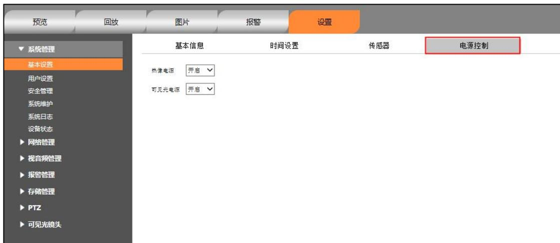
图 6-6 电源控制设置界面
